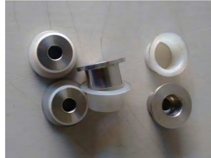
bucha em aço inox e capa em nylon
