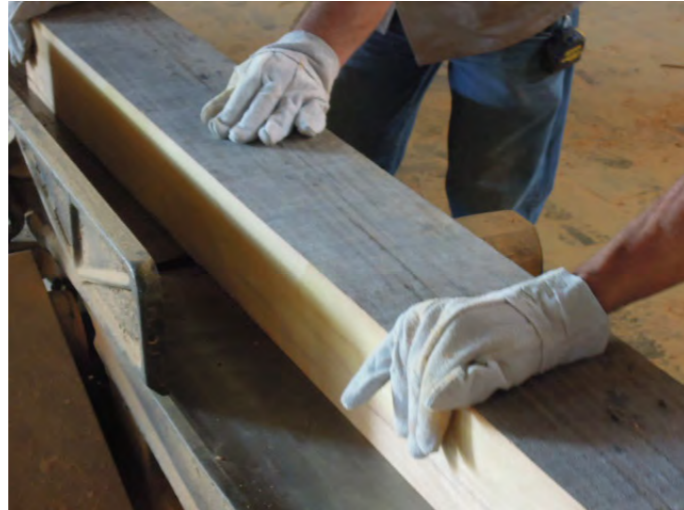
madeira maciça sendo desempenada
